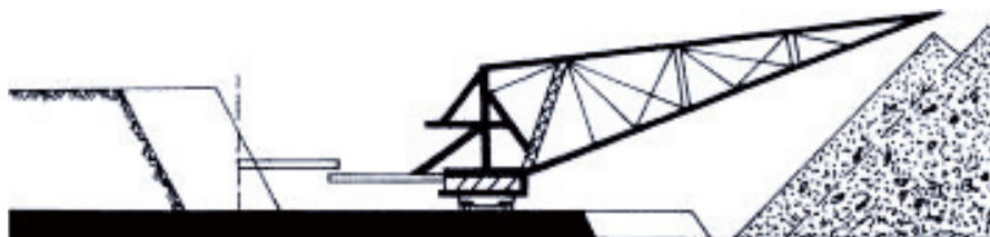
Сл. 97: Технолошка шема кај која конзолниот одлагач е сместен на таванот од корисната минерална суровина
