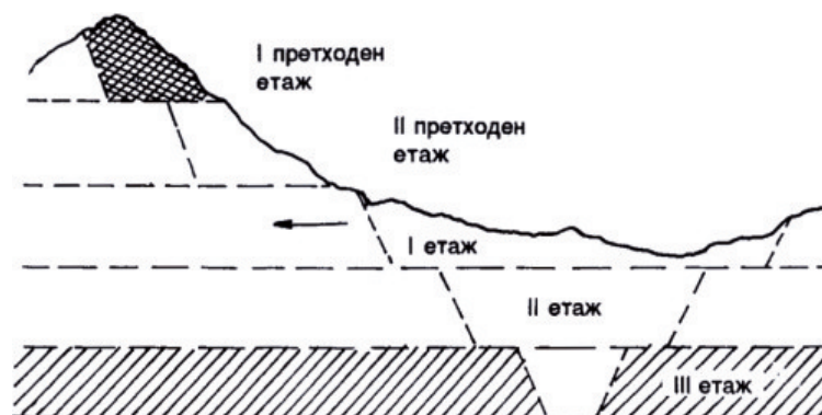
Сл. 30: Комбиниран начин на отворање на површински коп
