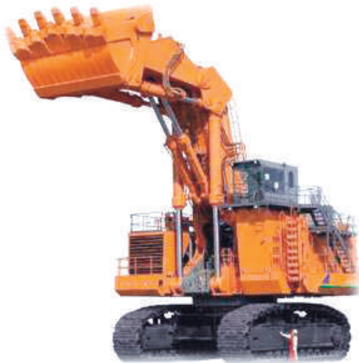
Сл. 153: Хидрауличен багер лажичар од фирмата Hitachi , модел EX8000
