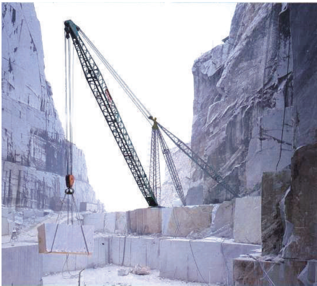
Сл. 203: Дерик Дигалка при извлекување на блокови од длабинскиот дел на површински коп
