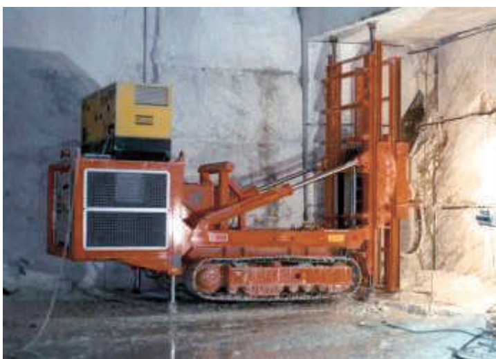
Сл. 178: Самоодна каменорезна машина производ Fantini model GU 70
