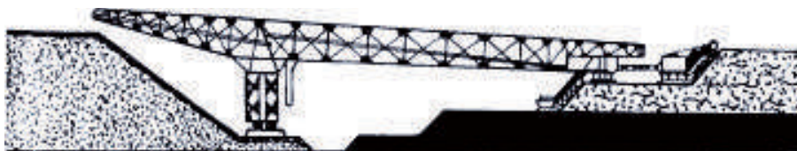
Сл. 95: Експлоатација со транспортен мост кај кои еден ослонец стои на депонијата со јаловина, а другиот на етажата од отквивката или корисната минерална суровина
