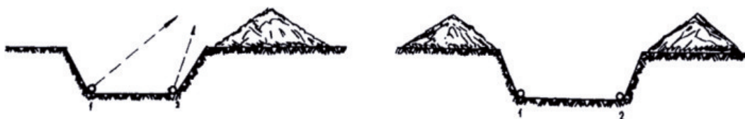
Сл. 71: Еднострано и двострано минирање при изработка на усек
