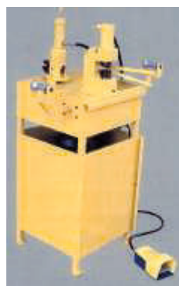
Сл. 168: Прибор за формирање дијамантска жица: 1-клешти; 2-монтажна маса; 3-рачна хидраулична преса
