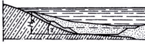
Сл. 12: Подводен површински коп
