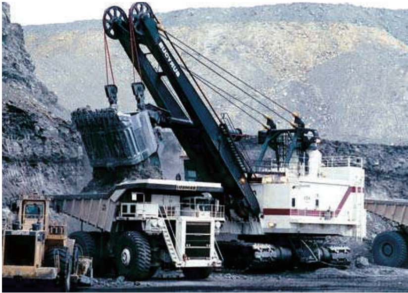
Сл. 148: Багер лажичар при товарење на откопаната суровина во камион
