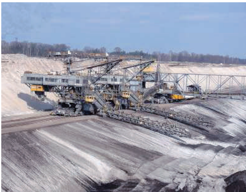
Сл. 132 : Работа на багер ведричар во реални услови (длабинско копање)
