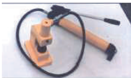
Сл. 168: Прибор за формирање дијамантска жица: 1-клешти; 2-монтажна маса; 3-рачна хидраулична преса
