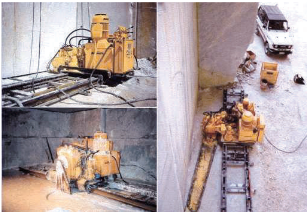
Сл. 175: Пнова изведна на машина Kogfmann поставена за изработување хоризонтален рез (десно) со пила, при изработување хоризонтален рез (горе лево) и при изработување вертикален рез (долу лево)
