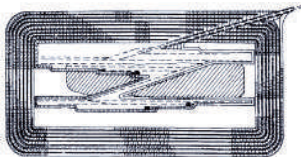
Сл. 49: Отворање со внатрешен стрмен усек
