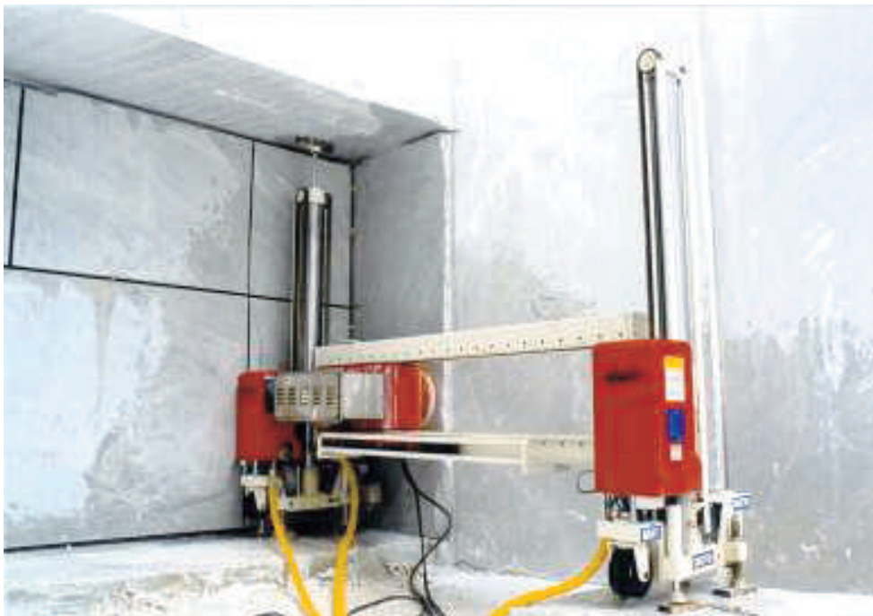
Сл. 185: Дијамантска ременска пила модел Tunnel Jet Belt Benetti macchine при подземно откопување
