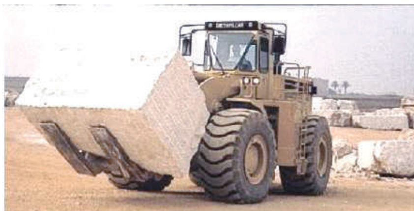
Сл. 204: Товарач со гумени тркала со поставена вилушка, наместо класичните товарни лопати при ракување со камени блокови
