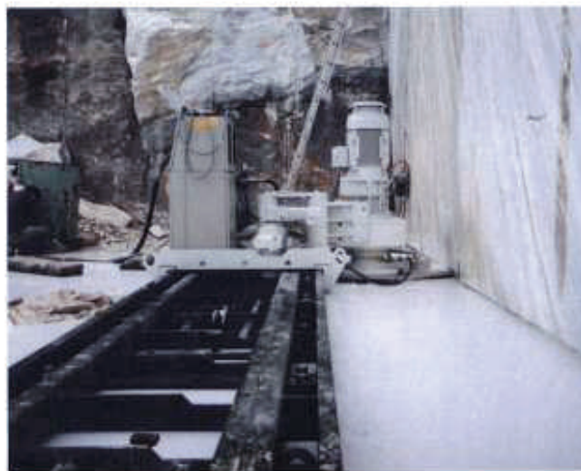
Сл. 181: Дијамантска ременска пила во различни фази на изработување на хоризонтален рез со пила
