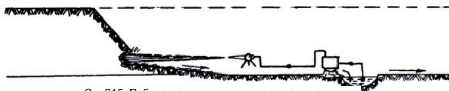
Сл. 215: Работа со хидромонитор на еден етаж
