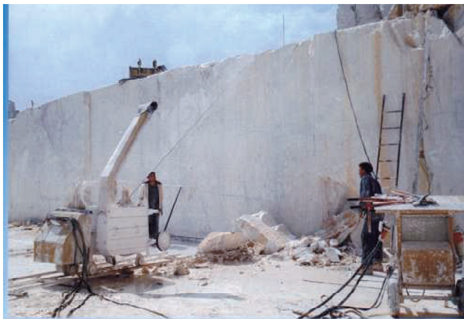
Сл.163: Дијамантска жична пила со автоматска регулација на напрегнатоста на жицата зависно од напрегањата во резот
