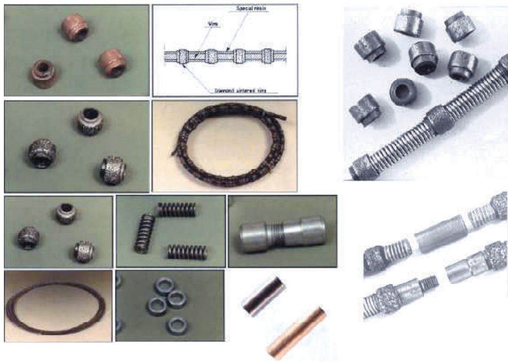
Сл. 167: Елементи од кои се формира дијамантската жица со нивно нанижување на челичното јаже: дијамантски перли (галвански и синтетизирани); разделни спирали; заштитни прстени; блокирни осигурувачи; спојници (цевкасти и спојници со машко женски навои)
