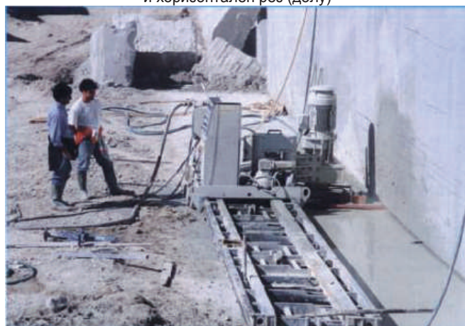
Сл. 180: Дијамантска ременска пила модел Super Jet Belt 950 при сечење хоризонтален рез со пила
