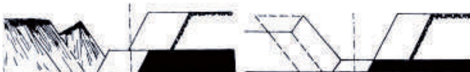
Сл. 84 и 85: Сложен бестранспортен метод на површинска експлоатација со повторно префрлување на откривката
