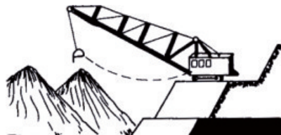
Сл. 83: Едноставен бестранспортен метод на површинска експлоатација - работа со багер дреглајн со делумно засипување на косината на етажата со корисната минерална суровина
