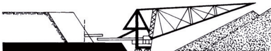
Сл. 98: Технолошка шема каде конзолниот одлагач е сместен на подот од корисната минерална суровина
