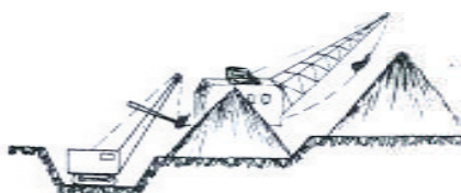
Сл. 57: Изработка на усек со бестранспортна метода со комбинирана работа на два багера
