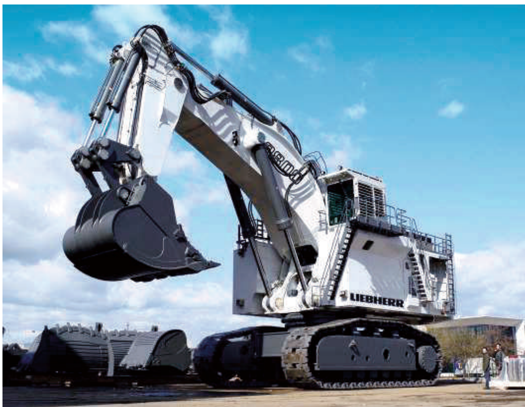
Сл. 154: Хидрауличен багер лажичар со обрната лажица од фирмата Liebherr, модел R9800
