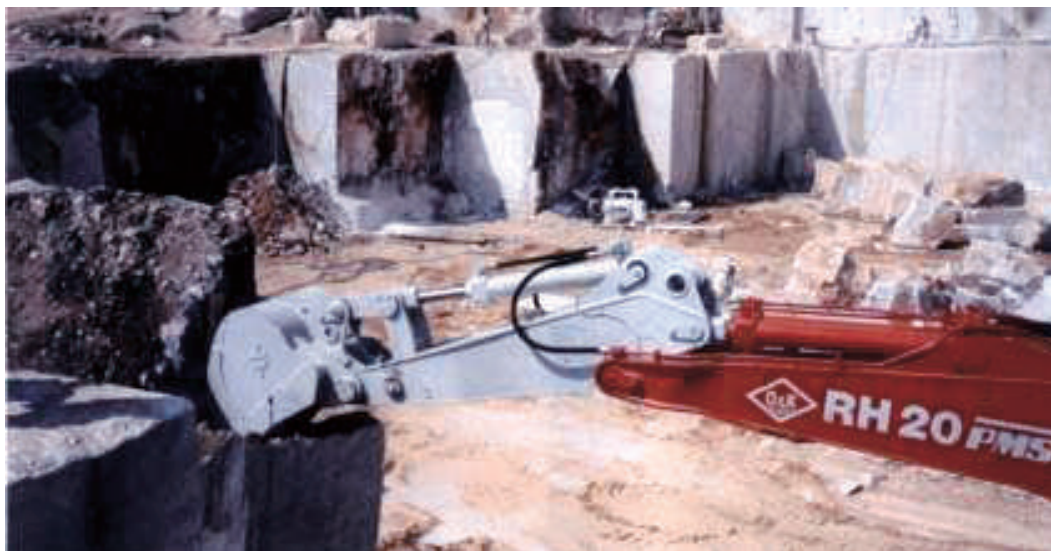
Сл. 194: Соборување на блок со маса 20\ t со хидрауличен багер со длабинска лопата O&K RH 20 со зафаќање на блокот од долната етажа
