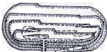
Сл. 116: Надолжен еднокрилен метод за експлоатација
