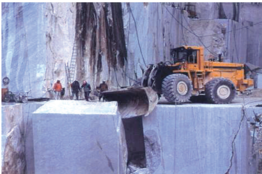
Сл. 193: Соборување на примарен блок со утоварувач
