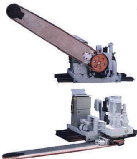
Сл. 179: Дијамантска ременска пила во положба за сечење вертикален рез (горе) со пила и хоризонтален рез (долу)
